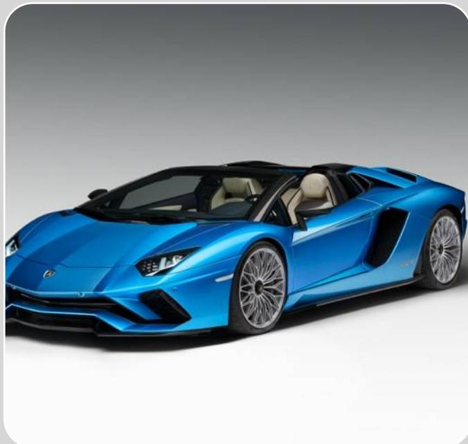
Basado en el Aventador S, Lamborghini ha presentado en la pasada edición del Salón del Automóvil de Frankfurt su **versión descapotable**, el Aventador S Roadster. Está equipado con el mismo motor que el modelo coupé, un **V12 de 6,5 litros** con un par motor de 690 Nm a 5.500 rpm, asociado a una **transmisión automática** de siete velocidades y
